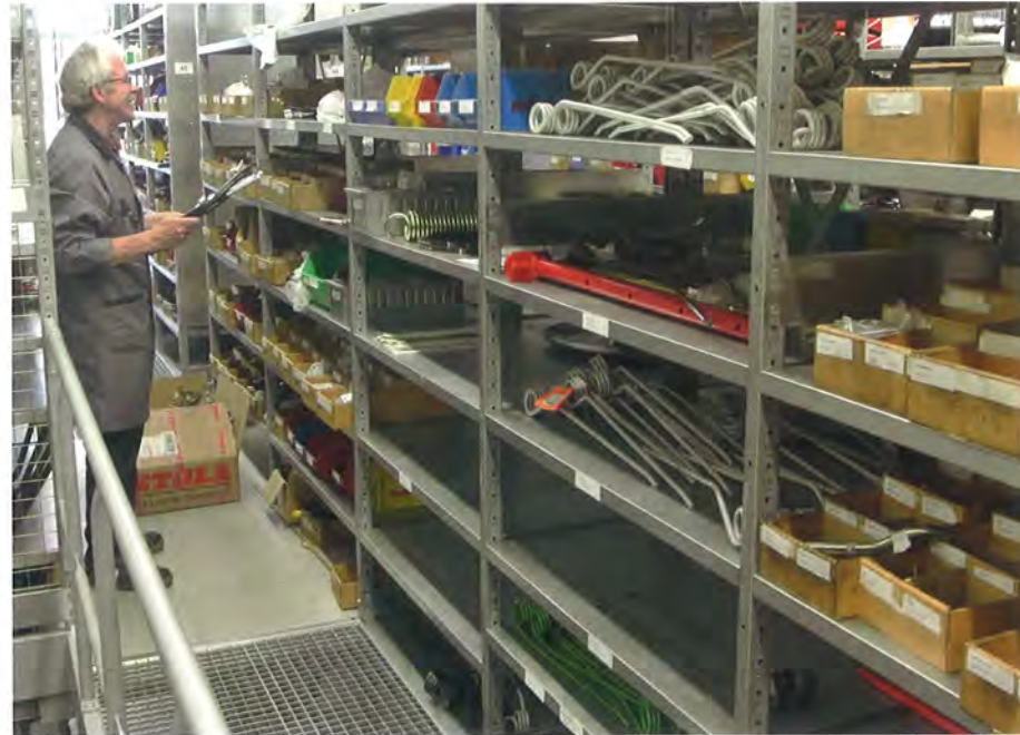
1 Ein zweigeschossiges modulares Regalsystem ermöglicht den sofortigen Zugriff auf fast jedes Ersatzteil.
