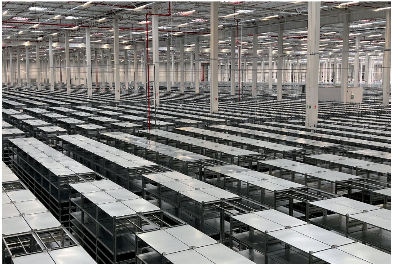
Grundregal mit Anbaufeldern
